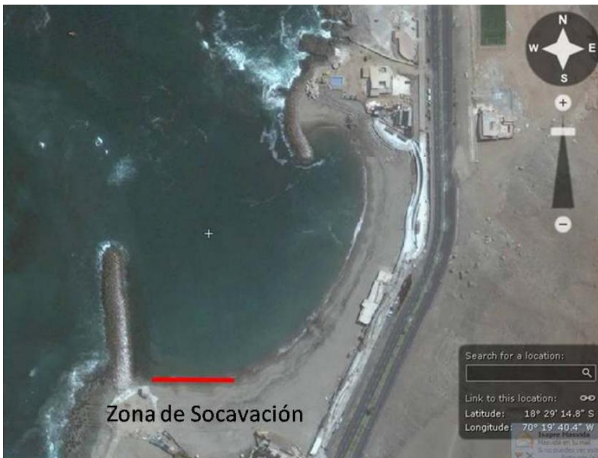
Figura 19. Vista en planta, playa El Lucho posterior al proceso de socavación. Fuente: Registro de Obras, Dirección de Obras Portuarias, MOP
